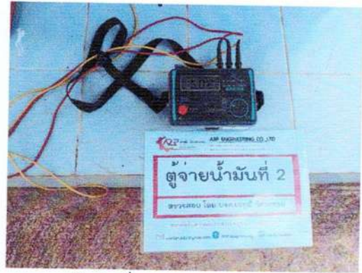
ทดสอบและตรวจสอบระบบไฟฟ้าพร้อมระบบป้องกันอันตรายจากฟ้าผ่าเพื่อประกอบการพิจารณาออกใบอนุญาตประกอบกิจการควบคุมน้ำมันเชื้อเพลิงของสถานีบริการน้ำมันเชื้อเพลิงในพื้นที่
